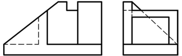
4. Donat un sòlid per les vistes en el sistema del primer dièdre, dibuixeu-ne la perspectiva isomètrica, amb totes les arestes ocultes, a **escala 15:7**, sense aplicar-hi coeficients de reducció. S'hi valora l'ús de l'escala gràfica. Preneu les mesures directament sobre la figura. (2,5 PUNTS)
