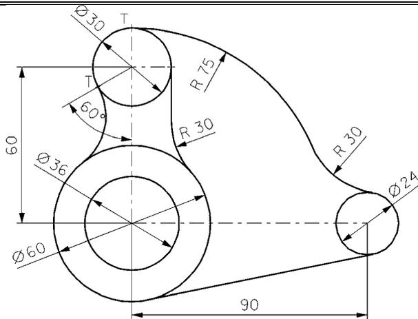
**1.-Dibuje el trazado de tangencias del croquis a escala 1:1.**
